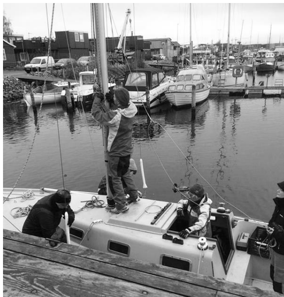
Masten monteres på en Spækhugger ved mastekranen på landpladsen.
